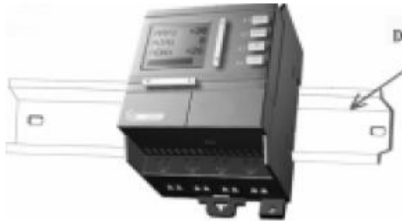
Рис. 2.1 Установка контроллера SR на стандартную DIN-рейку.
