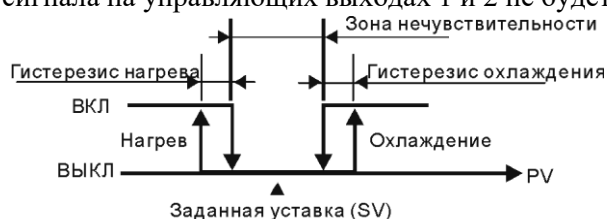
Рис.1. Двухконтурное управление при релейном регулировании (ВКЛ/ВЫКЛ)
