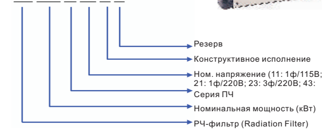
Система обозначения РЧ-фильтров (Delta Electronics):
